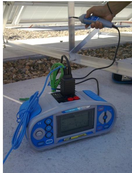
3. ábra Mérés Eurotest PV műszerrel
