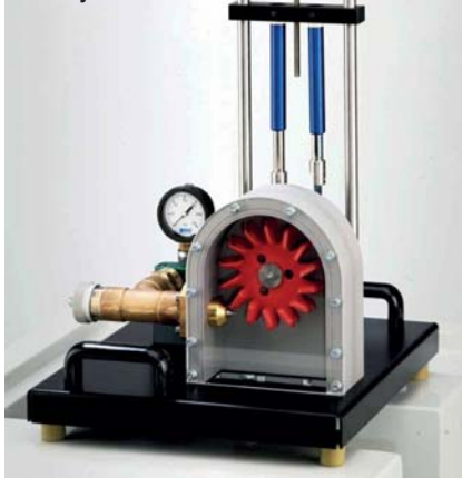
HM 150.19 – Pelton-turbina működő modellje
